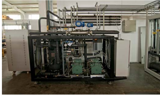
Şekil 24. CO 2 akışkan hazırlama ünitesi [27]
