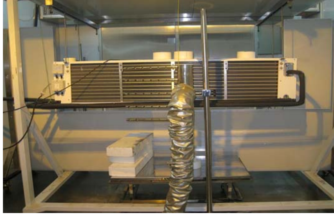
Şekil 23. Laboratuarda CO 2 Evaporatör Ürünü Testi [27]
